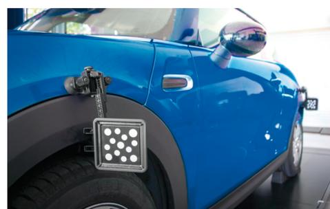
Keine manuelle Dateneingabe, schnellere Vermessung und höhere Genauigkeit dank unserer optionalen Targets zur Fahrzeugniveaumessung (TIP).
