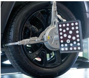
Die Radklammer greift mit optimaler Spannkraft auf Reifen an, ohne die Felge zu berühren, und sorgt so für eine sichere, schnelle und gleichmäßige Aufspannung.
